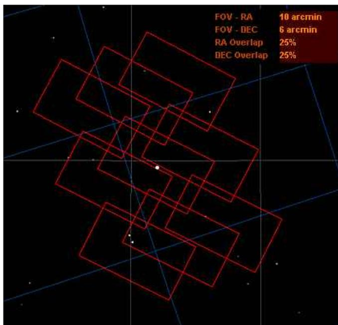
**Fig. 2.3** : Erreur d'alignement de 45° avec une superposition de 25%.
