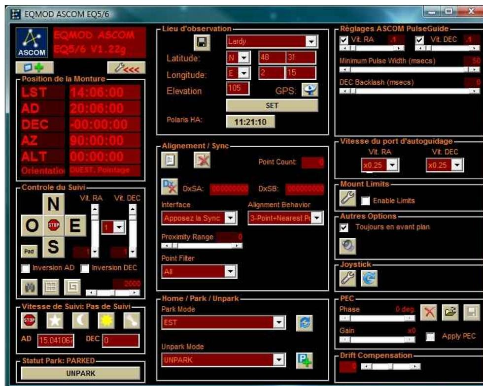
EQASCOM fournit une interface pour le serveur ASCOM au travers de laquelle de nombreux planétariums et applications d'autoguidage sont capables de contrôler la monture. EQASCOM ne fonctionne pas comme une application isolée mais elle est démarrée à la demande d'un client ASCOM. EQASCOM supporte l'utilisation simultanée de plusieurs clients ASCOM et se coupera avec la fermeture du dernier client.
